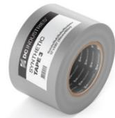
Synthetic Tape 3 è un tessuto non tessuto di poliestere spun-bonded, progettato per l'aggraffatura dell'erba artificiale. Il Synthetic Tape 3 è impermeabile e fornisce una resistenza superiore sia alla trazione sia allo strappo, requisito fondamentale per le installazioni di campi sportivi professionali. È adatto anche come nastro di aggraffatura per altre applicazioni in erba artificiale.
