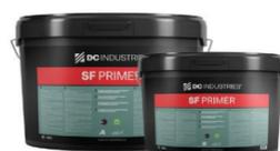
SF Primer è un primer bicomponente a base di resina epossidica in dispersione acquosa di colore beige. Una volta che i due componenti di SF Primer sono stati miscelati come specificato nella TDS e diluiti secondo le esigenze, può essere applicato a spruzzo, con un rullo, o a spruzzo airless in mani da 60 a 100 µm di spessore.
