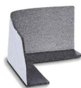
Sound Pro è una banda adesiva in polietilene espanso a celle chiuse applicata alle pareti perimetrali e intorno ai bordi degli elementi che attraversano i massetti per evitare la formazione di ponti acustici, progettata per essere facilmente applicata a forma di L.
