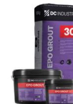
Epo Grout 3C è un prodotto tricomponente a base di resina epossidica, inerti selezionati di buona qualità e additivi speciali. Dopo aver miscelato il componente A di Epo Grout 3C con il relativo indurente (componente B) e il filler (componente C), si ottiene una miscela fluida che può essere facilmente versata e applicata in strati fino a 5 cm.
