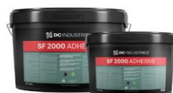
SF 2000 Adhesive è un adesivo poliuretano privo di solventi costituito da due componenti: la parte A, una pasta densa, e la parte B, un indurente di consistenza liquido fluida. Le quantità predosate dei due componenti in ogni contenitore facilitano la corretta miscelazione del prodotto; si ottiene una pasta di colore uniforme e facilmente applicabile manualmente con una spatola dentata.
