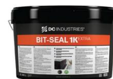
Bit-Seal 1K Extra è un'emulsione bituminosa impermeabilizzante monocomponente pronta all'uso. Contiene sfere di polistirolo e granuli di gomma che contribuiscono ad aumentarne la resa, a ridurre il ritiro e a conferire al prodotto elevate capacità di crack-bridging, ha una notevole flessibilità.
