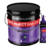
Epo Inject Bar 100 è una resina epossidica bicomponente per iniezione, priva di solventi, liquida e sottile a ritiro zero. La sua fluidità permette la regolazione di piccole crepe. Presenta un'alta adesione nel cemento armato e nell'acciaio. Ha un'alta resistenza alla compressione, alla flessione e agli acidi. Non è influenzato da alcali, gelate e umidità.
