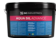
Aqua Sil Advance è una pasta monocomponente utilizzata come membrana impermeabilizzante, isolamento acustico e ripara crepe. Applicata a spatola sul calcestruzzo adeguatamente preparato ed a piena maturazione strutturale (uso interno solo da asciutto). Aqua Sil Advance può essere utilizzato con sottostrati a base di gesso in installazioni asciutte con resistenze di compressione minime di 2.000 psi.
