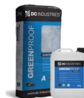
Greenproof Elastic è una malta bicomponente a base di leganti cementizi, inerti selezionati a grana fine, additivi speciali e polimeri sintetici in dispersione acquosa. Miscelando i due componenti si ottiene un impasto di consistenza plastica. Grazie al contenuto e all'alta qualità delle resine sintetiche, lo strato indurito di Greenproof Elastic rimane costantemente flessibile in tutte le condizioni ambientali.
