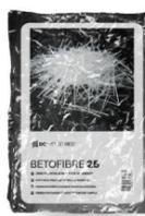
Betofibre 25 sono bres polimeriche di 25 mm di lunghezza progettate per l'applicazione di massetti. Betofibre 25 è anche una valida alternativa alla rete elettrosaldata utilizzata per la distribuzione dei carichi e permette un miglior controllo della propagazione delle fessure causate dal ritiro idraulico.
