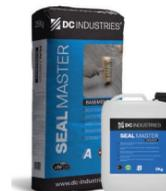
Seal Master Basement è una malta flessibile bicomponente a base di leganti cementizi, inerti selezionati a grana fine, fibre inorganiche, additivi speciali e polimeri sintetici in dispersione acquosa. Mescolando i due componenti si ottiene una consistenza plastica di facile applicazione. Il prodotto può essere applicato a rullo o a spruzzo sia su superfici orizzontali che verticali, con uno spessore minimo di 2 mm.
