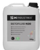
Betofluid N20 è una soluzione acquosa di polimeri attivi che disperdono i granuli di cemento. La particolare azione dell'additivo può essere regolata per ottenere i risultati richiesti (aumento della resistenza, miglioramento della lavorabilità, riduzione del fattore cemento) variando il dosaggio tra lo 0,5% e l'1,5% in peso di cemento: più significativo è il dosaggio, maggiore è l'effetto.
